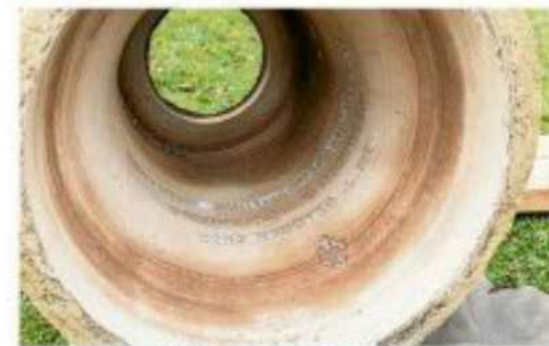
Die Glockenform mit der spiegelverkehrten Inschrift.
